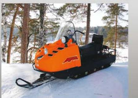
Серийно комплектуется фарой прожектором, предназначеннной для освещения участков местности и объектов, расположенных вне зоны, освещаемой основной фарой.
