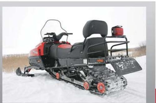
На снегоходе ТАЙГА АТАКА II СТ-551ДР установлен двигатель мощностью 65 л.с. жидкостного охлаждения, оснащенный двумя карбюраторами «Mikuni» и лепестковыми клапанами на впуске, которые наделяют двигатель большим запасом тяги «на низах».
